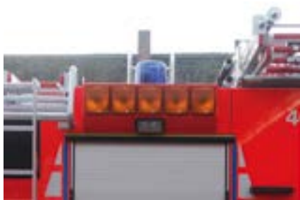
Bild 8 Beispiel für ein Fahrzeug-Heckwarnsystem mit 5 Blinkleuchten
